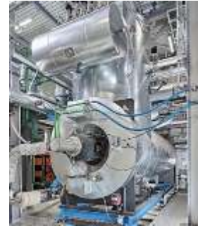
Bild: Prinzipdarstellung Vakuumtrockner der Firma BHS-Sonthofen GmbH (ehemals AVA)
