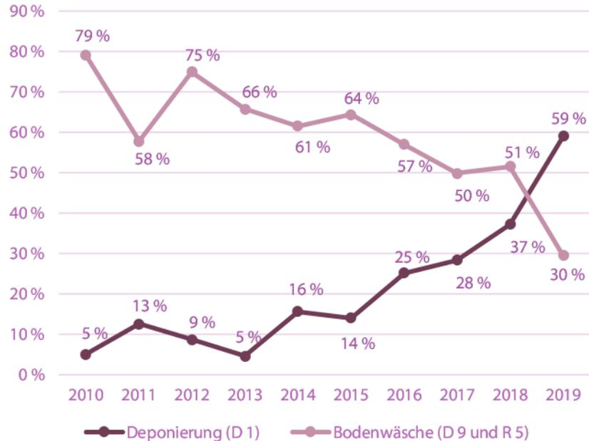
Entwicklung Deponierung vs. Bodenwäsche für die grundsätzlich in Bodenwaschanlagen behandelbare Abfallarten aus dem **Tiefbau**, (belastete Böden 170503\* und Baggergut 170505\*)
